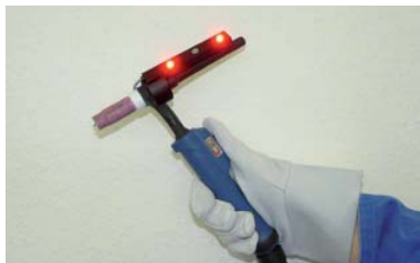
Uchwyty MIG/TIG wraz z zamontowanymi systemami monitorującymi pracę
