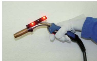
Uchwyty MIG/TIG wraz z zamontowanymi systemami monitorującymi pracę
